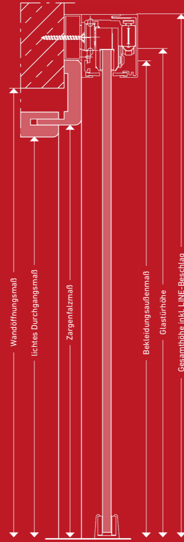
Vertikalschnitt Ganzglas-Schiebetür mit Zarge
