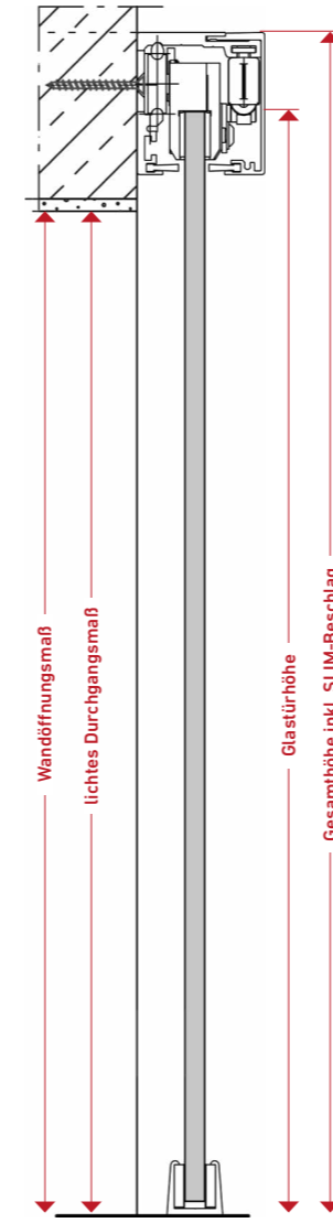
Vertikalschnitt Ganzglas-Schiebetür ohne Zarge
