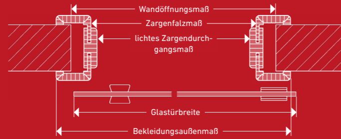
Ganzglas-Schiebetür mit Zarge, SLIM-Beschlag ohne Anschlagkasten
